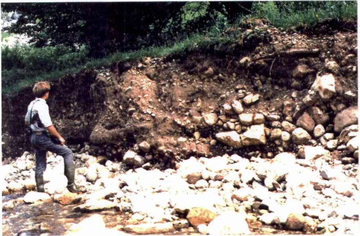
Fotografía nº4.- Perfil litológico del aluvial visto desde el interior del nuevo cauce. Observar gradación granulométrica.
