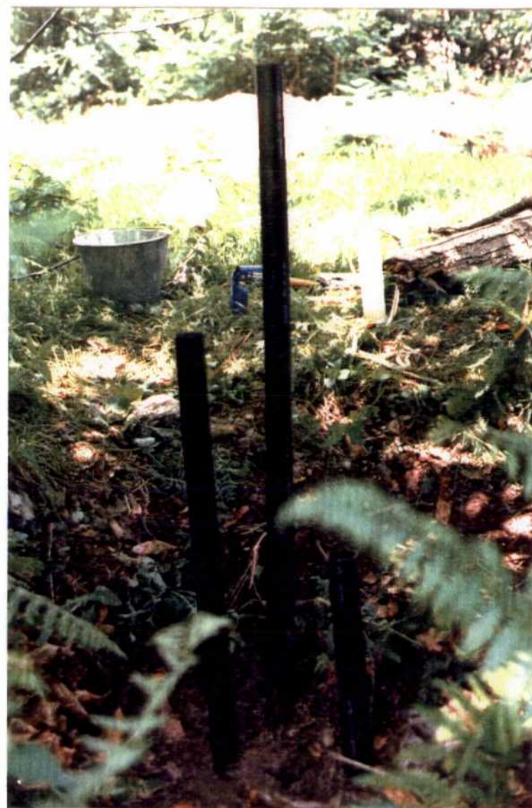
Fotografía nº 7.- Ensayo de pérdida de agua con carga constante (nº 2)
